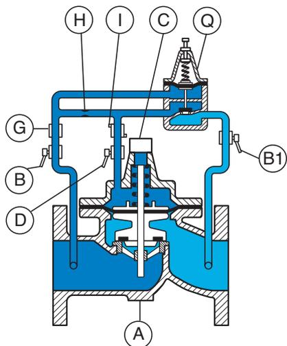
Quand la pression amont devient inférieure à la pression de consigne donnée par le pilote (Q), celui-ci tend à se fermer et à limiter le débit traversant.
