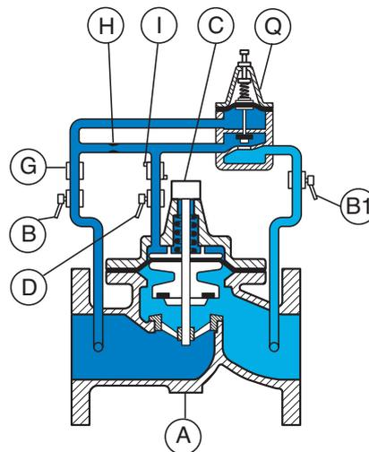
Quand la pression amont augmente, le pilote (Q) tend à s'ouvrir et donc à évacuer la pression s'appliquant sur la membrane de la vanne principale (A). Celle-ci s'ouvre.
