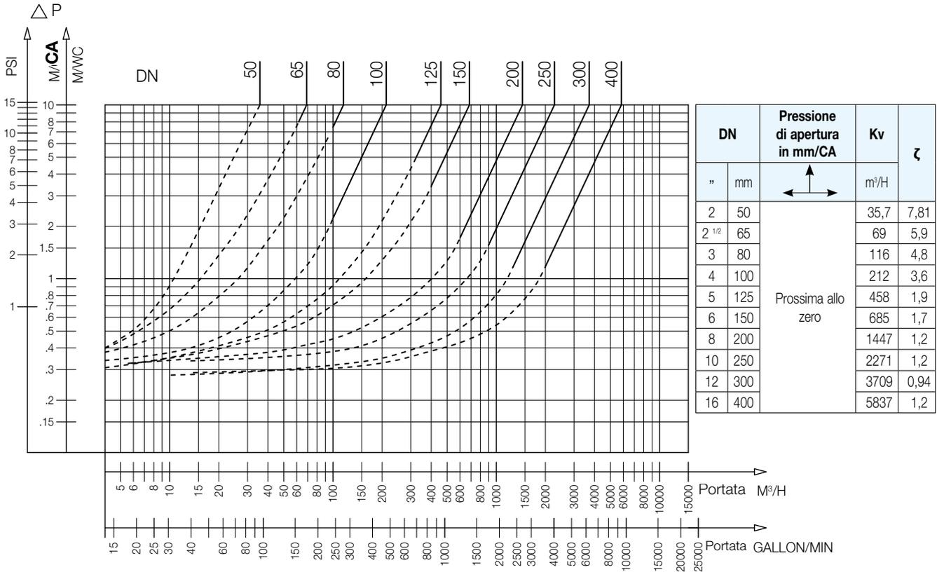
895 V - Diagramma delle perdite di carico
